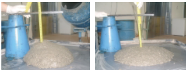
Figura 1 – Tipiche consistenze del calcestruzzo XS1 allo stato fresco. La scelta della consistenza è di fondamentale importanza per evitare difetti di costipazione (ex. vespai) ed è funzione delle difficoltà esecutive oltre che dell'affidabilità della manodopera in cantiere.
