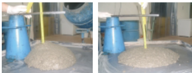
Figura 1 – Tipiche consistenze del calcestruzzo XF4 allo stato fresco. La scelta della consistenza è di fondamentale importanza per evitare difetti di costipazione (ex. vespai) ed è funzione delle difficoltà esecutive oltre che dell'affidabilità della manodopera in cantiere.
