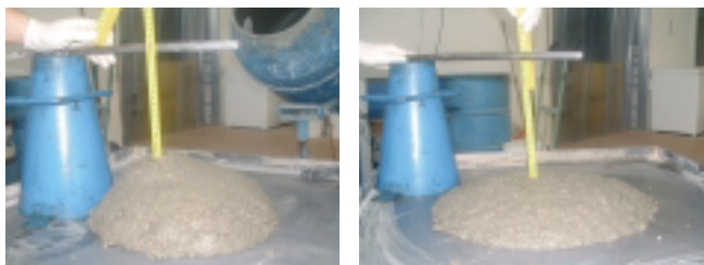
Figura 1 – Tipiche consistenze del calcestruzzo XF1 allo stato fresco. La scelta della consistenza è di fondamentale importanza per evitare difetti di costipazione (ex. vespai) ed è funzione delle difficoltà esecutive oltre che dell'affidabilità della manodopera in cantiere.
