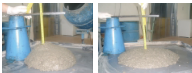
Figura 1 – Tipiche consistenze del calcestruzzo XD3 allo stato fresco. La scelta della consistenza è di fondamentale importanza per evitare difetti di costipazione (ex. vespai) ed è funzione delle difficoltà esecutive oltre che dell'affidabilità della manodopera in cantiere.
