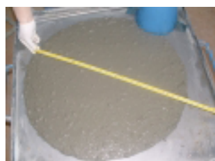
Figura 1 – Tipiche consistenze del calcestruzzo XC4 allo stato fresco. La scelta della consistenza è di fondamentale importanza per evitare difetti di costipazione (ex. vespai) ed è funzione delle difficoltà esecutive oltre che dell'affidabilità della manodopera in cantiere.
