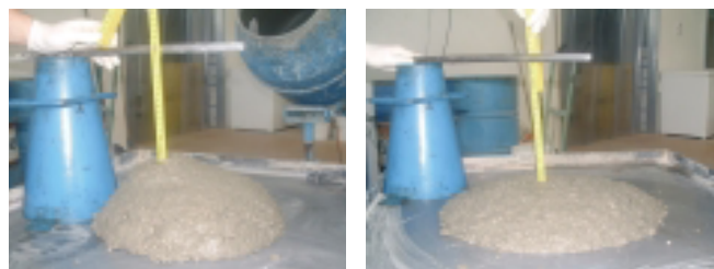
Figura 1 – Tipiche consistenze del calcestruzzo XC4 allo stato fresco. La scelta della consistenza è di fondamentale importanza per evitare difetti di costipazione (ex. vespai) ed è funzione delle difficoltà esecutive oltre che dell'affidabilità della manodopera in cantiere.
