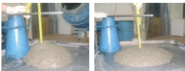
Figura 1 – Tipiche consistenze del calcestruzzo XC3 allo stato fresco. La scelta della consistenza è di fondamentale importanza per evitare difetti di costipazione (ex. vespai) ed è funzione delle difficoltà esecutive oltre che dell'affidabilità della manodopera in cantiere.
