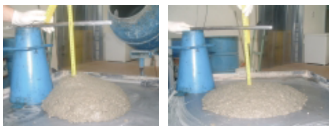
Figura 1 – Tipiche consistenze del calcestruzzo XC2 allo stato fresco. La scelta della consistenza è di fondamentale importanza per evitare difetti di costipazione (ex. vespai) ed è funzione delle difficoltà esecutive oltre che dell'affidabilità della manodopera in cantiere.
