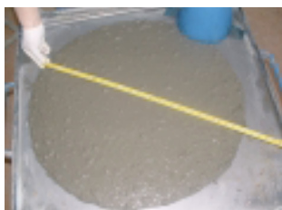
Figura 1 – Tipiche consistenze del calcestruzzo XC1 allo stato fresco. La scelta della consistenza è di fondamentale importanza per evitare difetti di costipazione (ex. vespai) ed è funzione delle difficoltà esecutive oltre che dell'affidabilità della manodopera in cantiere.
