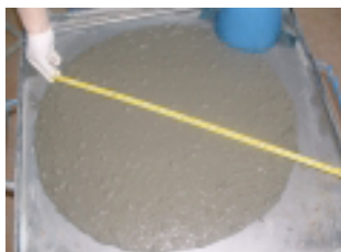
Figura 1 – Tipiche consistenze del calcestruzzo XA2 allo stato fresco. La scelta della consistenza è di fondamentale importanza per evitare difetti di costipazione (ex. vespai) ed è funzione delle difficoltà esecutive oltre che dell'affidabilità della manodopera in cantiere.
