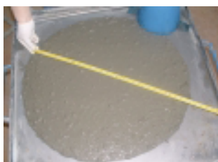
Figura 1 – Tipiche consistenze del calcestruzzo XA1 allo stato fresco. La scelta della consistenza è di fondamentale importanza per evitare difetti di costipazione (ex. vespai) ed è funzione delle difficoltà esecutive oltre che dell'affidabilità della manodopera in cantiere.
