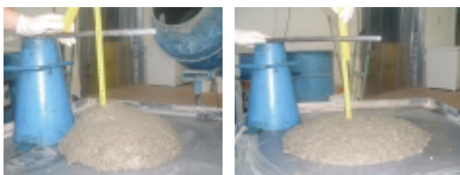
Figura 1 – Tipiche consistenze del calcestruzzo XA1 allo stato fresco. La scelta della consistenza è di fondamentale importanza per evitare difetti di costipazione (ex. vespai) ed è funzione delle difficoltà esecutive oltre che dell'affidabilità della manodopera in cantiere.
